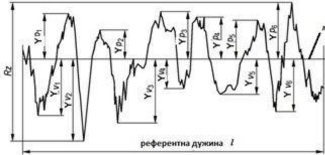
Средња аритметичка вредност одступања  $R_a$  свих тачака ефективног профила у односу на средњу линију  $n$ , на референтној дужини  $l$ , рачуна се по образцу:
